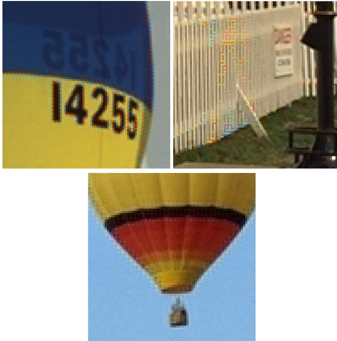
FIGURA 15: Artefactes comuns als algorismes de demosaicking . D'esquerra a dreta: aliasing donat pels colors vermell i blau, interpolació errònia de les direccions i l'efecte de zipper .
